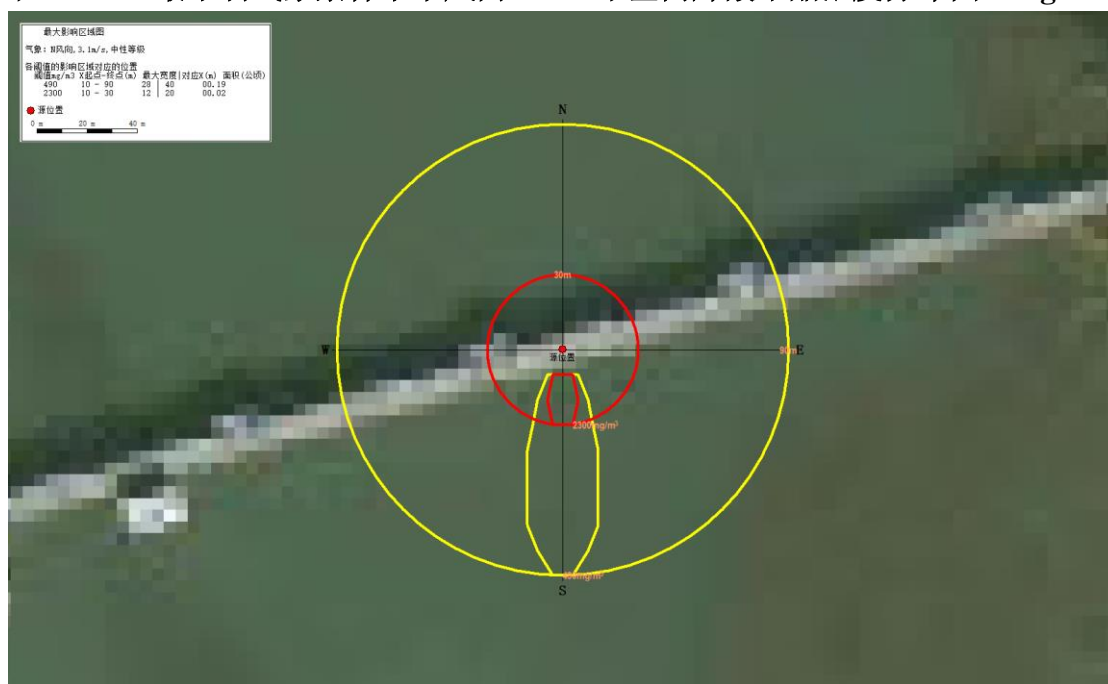
图 5.3.1-4 最常见气象条件下风向(N)甲基丙烯酸甲酯浓度分布图 ( \text{mg}/\text{m}^3 )
