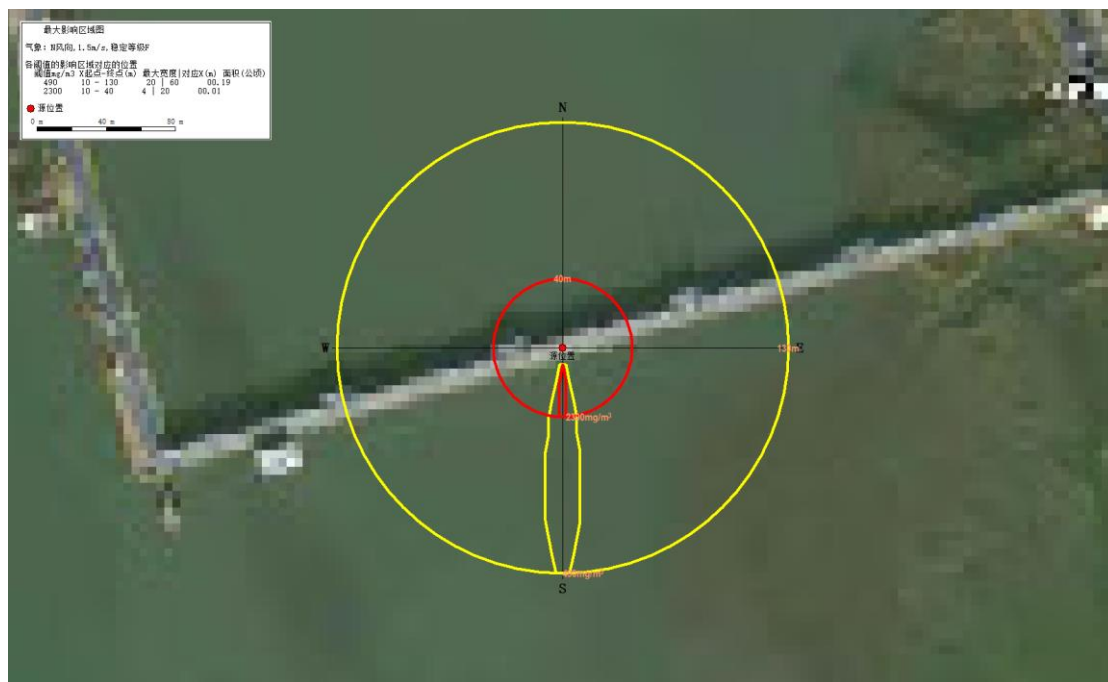
图 5.3.1-3 最不利气象条件下风向(N)甲基丙烯酸甲酯浓度分布图 ( \text{mg}/\text{m}^3 )
